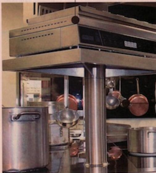
**SUL PIANO INFERIORE DELLA SALAMANDRA** è stato installato un sistema di illuminazione per evitare la formazione di coni d'ombra. In questo modo la zona è fruibile per la finitura dei piatti e allo stesso tempo risulta più agevole controllare che tutto sia sempre perfettamente pulito. Al bordo possono essere appesi gli attrezzi
